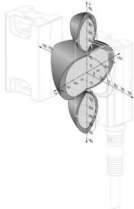
Si la dirección de ataque del actuador y del interruptor de seguridad es lateral, debe mantenerse una distancia mínima de  $s = 6$  mm con objeto de evitar la entrada en la zona de reacción de los lóbulos laterales.
