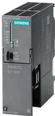
SIMATIC S7-300 CPU 315-2 PN/DP, Módulo central con memoria de trabajo de 384 kbytes, 1.<sup>a</sup> interfaz MPI/DP 12 Mbits/s, 2.<sup>a</sup> interfaz Ethernet PROFINET, con switch de 2 puertos, Se necesita Micro Memory Card
