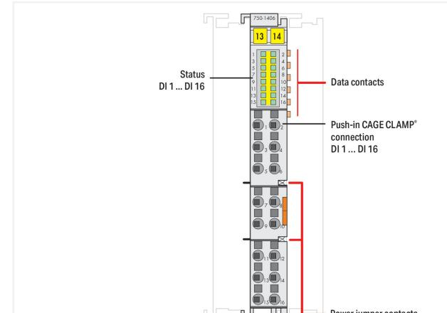
Este módulo de entrada digital incorpora 16 canales en una anchura de tan solo 12 mm.
