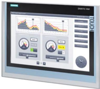
SIMATIC HMI TP1500 Comfort, Comfort Panel, mando táctil, pantalla TFT panorámica de 15", 16 millones de colores, interfaz PROFINET, interfaz MPI/PROFIBUS DP, memoria de configuración de 24 MB, WEC 2013, configurable a partir de WinCC Comfort V14 SP1 con HSP, temperatura ambiente hasta 50 °C (hasta 55 °C con limitaciones)
